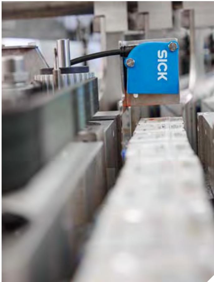
Nach dem Zählen: exakte Beschickung der Bahnen mit der richtigen Anzahl von Getränkeverpackungen.
