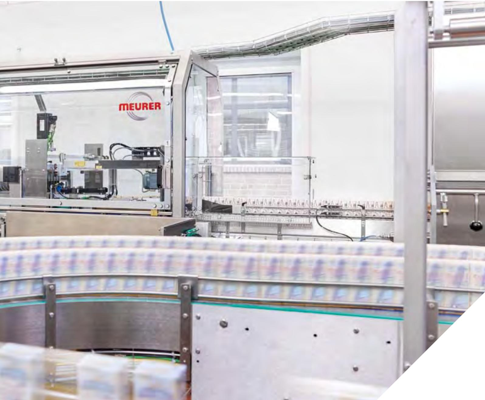
✎ Hochleistungsverpackungsmaschine CM/HTW von meurer. Die Maschine formt Kartonumverpackungen, gefüllt mit Produkten wie Getränkeverpackungen, Saucenflaschen oder Konservengläsern, und leitet die fertig kommissionierten Gebinde weiter.
