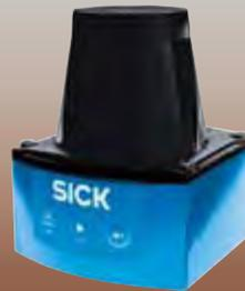
Laserscanner TIM3xx – sehr hohe Messgenauigkeit und Fremdlichtunempfindlichkeit, Überwachungszone von bis zu 10m, kann mit PC oder per „Touch and Teach“-Parametrierung mit vorkonfigurierten Feldsätzen eingerichtet werden.
