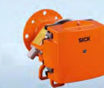
In-situ-Gasanalytator GM35 – misst CO<sub>2</sub> und CO oder N<sub>2</sub>O simultan. Sende-Empfangs-Einheit und Reflektor liegen am Gaskanal gegenüber. So durchläuft der Lichtstrahl zur Erhöhung der Genauigkeit den gesamten Kanaldurchmesser zweimal; mit integriertem Selbsttest und Kontrollfunktionen.
